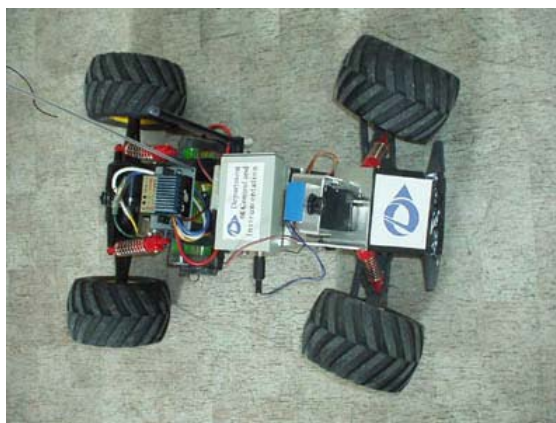
Obr. 6.6 Teleprezenčně ovládaný minirobot s Ackermanovým podvozkem, UAMT
