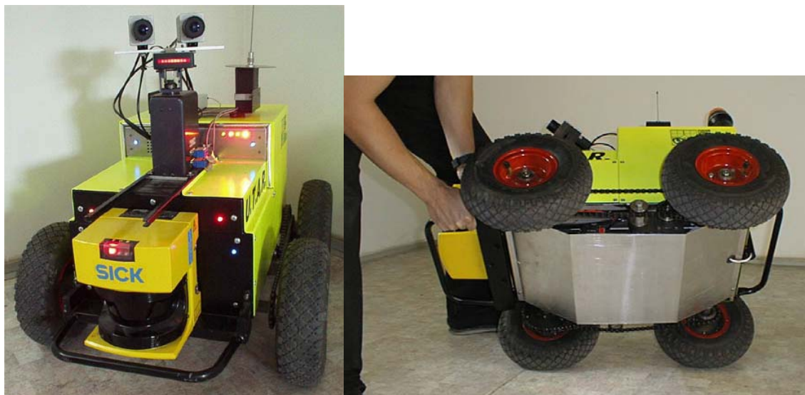
Obr 6.10 Robotický systém U.T.A.R. – kolový podvozek s koly s jedním stupněm volnosti provázanými řetězem, vyvinuto na UAMT
