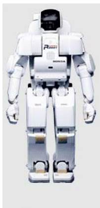
Obr. 6.12 Humanoidní kráčející robot Honda P3: výška 160mm, hmotnost 130kg
