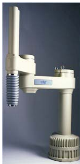
Obr.2.6. Robot ADEPT koncepce SCARA
