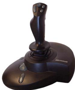
Obr. Joystick Microsoft Sidewinder Forcefeedback Pro se silovou zpětnou vazbou ve dvou osách
