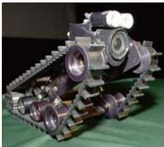
Obr. 6.9 Robot Bujold z University of South Florida je typickým představitelem robotu s pásovým podvozkem
