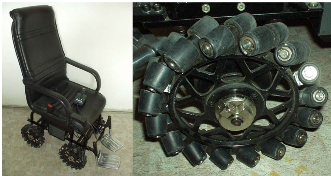
Obr. 6.7 Křeslo se všesměrovými koly typu Mecanum (vlevo), detail všesměrového kola (vpravo); zakoupeno na UAMT
