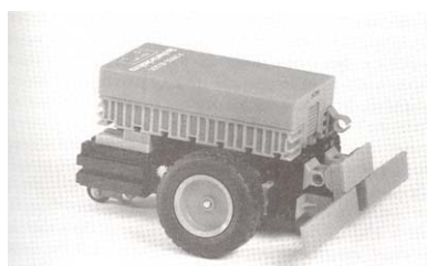
Obr. 8.4 Jednoduchý mobilní robot s taktilními senzory
