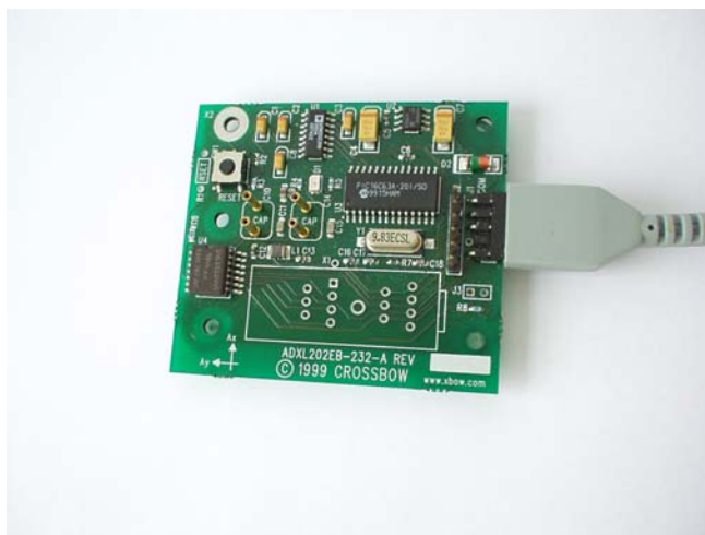
Obr 8.2 Vývojová deska pro akcelerometr ADXL202 firmy Analog Devices
